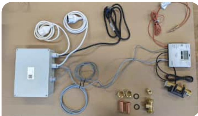
Meeteenheid voor de door de ketel en hybride opgenomen stroom, en de aan de installatie afgegeven hoeveelheid warmte middels flow en delta-T, aanvoer- en retourtemperatuur, meting.
